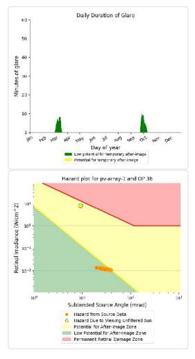
PV array 1 - OP Receptor (OP 37)
